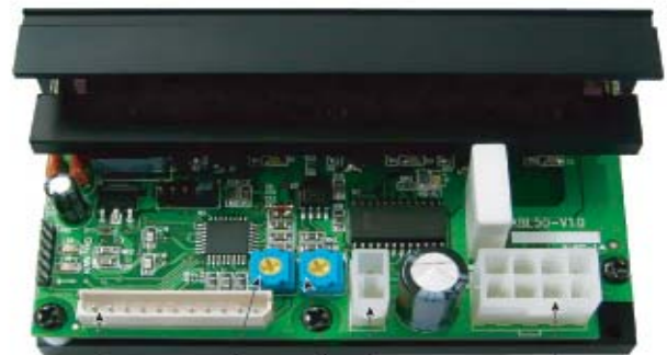
UI, UO 커버터 최대 허용토크 가감속 속도지정 DC.24V 전원커넥터 모터 커넥터 (MOT)
